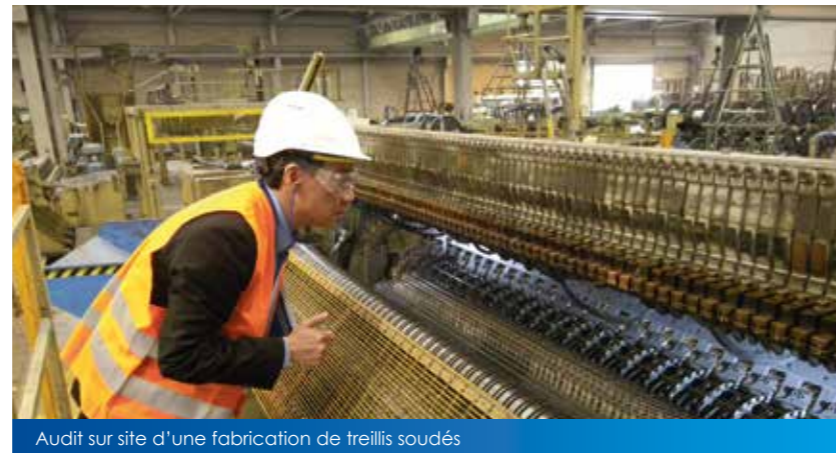
Audit sur site d'une fabrication de treillis soudés
